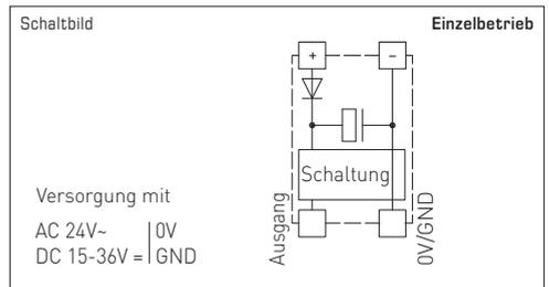
Werden mehrere Geräte von einer 24V **AC-Spannung** versorgt, ist darauf zu achten, dass alle „positiven“ Betriebsspannungseingänge (+) der Feldgeräte miteinander verbunden sind, sowie alle „negativen“ Betriebsspannungseingänge (-) = Bezugspotential miteinander verbunden sind (phasengleicher Anschluss der Feldgeräte). Alle Feldgeräteaengänge müssen auf das gleiche Potential bezogen werden!
