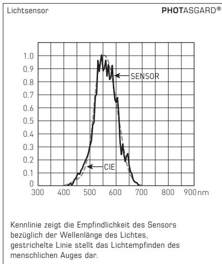
Der in den **PHOTASGARD®** Helligkeitsfühlern verwendete Sensor wurde speziell an die Augenempfindlichkeit angepasst. Seine größte Empfindlichkeit liegt im Bereich von 350 nm bis 820 nm. Mit seinem Spezialfilter ist der Sensor somit für den Einsatz zur Belichtungsmessung von Tageslicht und / oder zur Messung von Kunstlicht mit hoher Farbtemperatur (ähnlich dem Sonnenlicht) prädestiniert.
