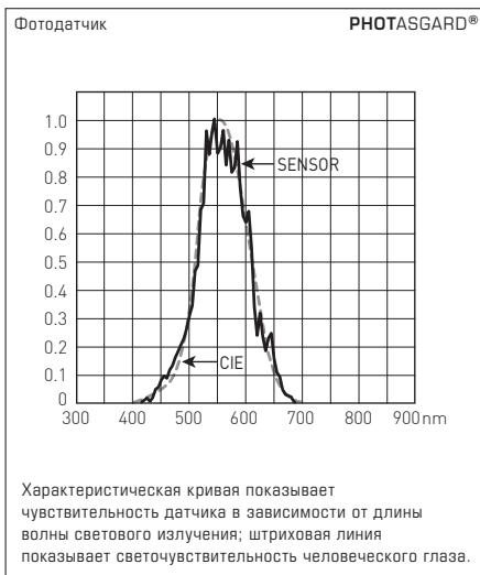
Чувствительный элемент, используемый в датчиках PHOTASGARD® специально адаптирован к чувствительности человеческого глаза. Максимум чувствительности глаза лежит в диапазоне от 350 нм до 820 нм. Датчик оснащается специальным фильтром, благодаря чему может использоваться для измерения освещенности дневного света и/или для измерения искусственного освещения с высокой цветовой температурой (аналогично солнечному свету).
