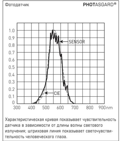
Чувствительный элемент, используемый в датчиках PHOTASGARD® специально адаптирован к чувствительности человеческого глаза. Максимум чувствительности глаза лежит в диапазоне от 350 нм до 820 нм. Датчик оснащается специальным фильтром, благодаря чему может использоваться для измерения освещенности дневного света и/или для измерения искусственного освещения с высокой цветовой температурой (аналогично солнечному свету).
