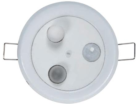
Der Deckeneinbaufühler **KINASGARD® DBWF/LF/FTF** dient zur Erfassung von Personen im Abstand bis zu 10 Meter, der Beleuchtungsstärke bzw. Helligkeit, der relativen Luftfeuchte und der Temperatur. Er wird verwendet zum Einbau in Zwischendecken.
