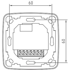
Elektronischer Einzelraumregler / Uhrenthermostat mit Wochenprogramm **THERMASREG® RTR-E-UP** mit internem Fühler oder mit Fernfühler 4 m zur Unterputzmontage, geeignet zur Temperaturüberwachung oder -regelung bzw. zur Ansteuerung von Heizungen aller Art, für Ventile (stromlos geschlossen), als Raumtemperaturregler, als Raumthermostat, Fußbodentemperaturregler oder Uhrenregler, z.B. für Elektro-, Fußbodendirektheizungen, Badezimmer, Nachtspeicher, Wand-, Decken- und Gasheizungen.
