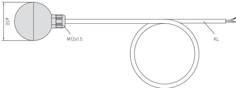
Widerstandsthermometer **THERMASGARD® RPTF 1** mit passivem Ausgang, das speziell zur Temperaturerfassung in größeren Räumen oder Hallen dient. Aufgrund der angewandten Messmethode beim Raumpendelfühler und der Positionierung im Raum wird ein sehr gutes und für den Messraum repräsentatives Messergebnis erzielt, da der Fühler gleichmäßig von der umgebenden Raumluft umspült wird.
