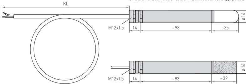
**SF-M** mit **Metall**-Sinterfilter (optional)
