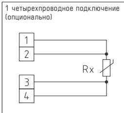
**THERMASGARD® RPTF Датчик температуры в помещении маянкового типа**
